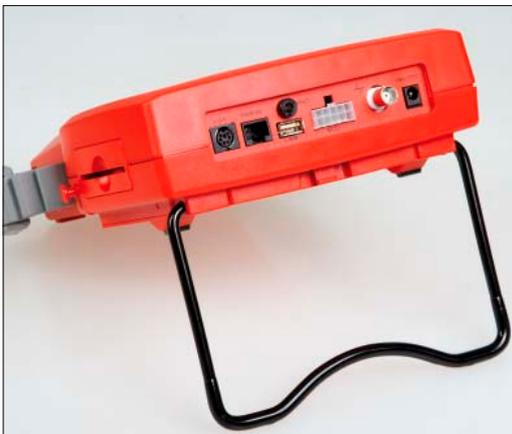
Der Klappbügel sorgt für ein sicheres Aufstellen bzw. Einhängen.
