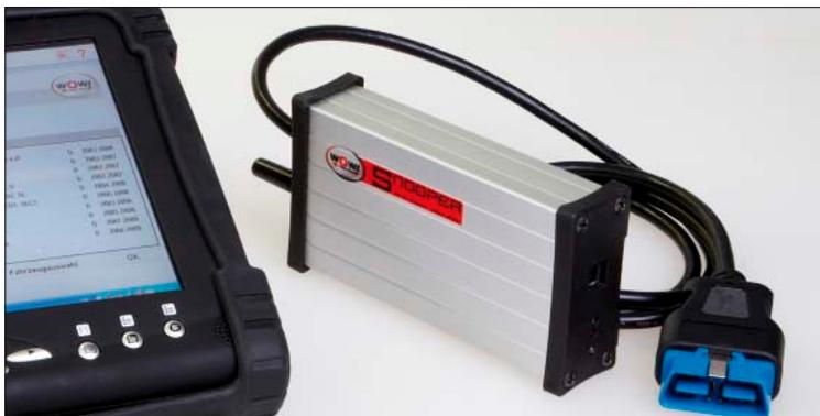
Die Verbindung zum Fahrzeug stellt die Schnittstelle „Snooper“ mittels Bluetooth-Anbindung her.
