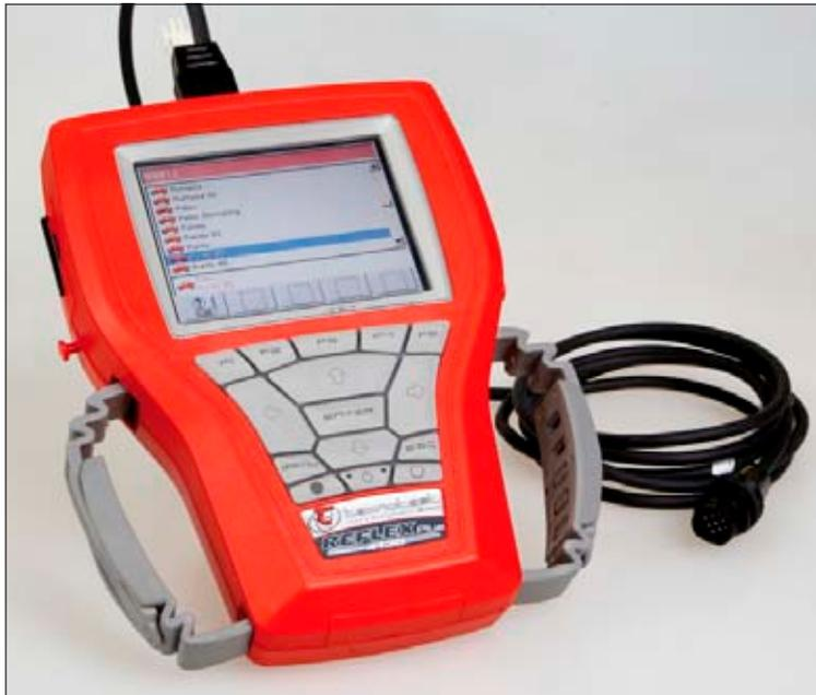
Der Reflex kommuniziert direkt mit dem Fahrzeug – eine separate Schnittstelle ist nicht notwendig.
