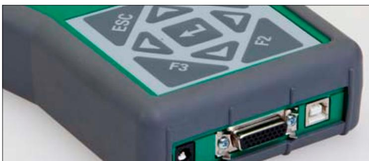
*Alle Geräteanschlüsse befinden sich beim Mega Macs 42 an der Unterseite.*
