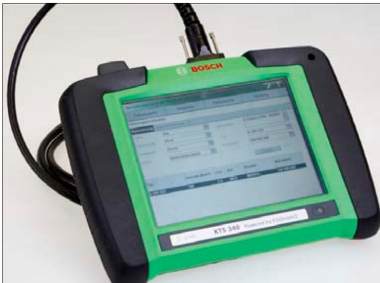
Ein robustes Kunststoffgehäuse mit Gummierung schützt den KTS 340 und erleichtert die Handhabung.
