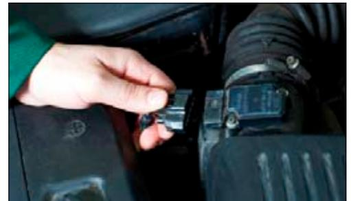
Die Prüfer versahen die zehn Testfahrzeuge mit typischen Elektrik-/Elektronikfehlern wie z. B. einer Unterbrechung des Luftmassenmessers.
